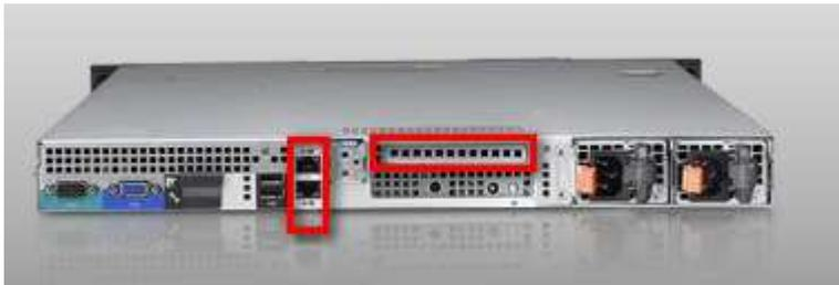
位于左边的红框为板载Broadcom网卡，位于右边的红框为需要加入的Silicom网卡。
